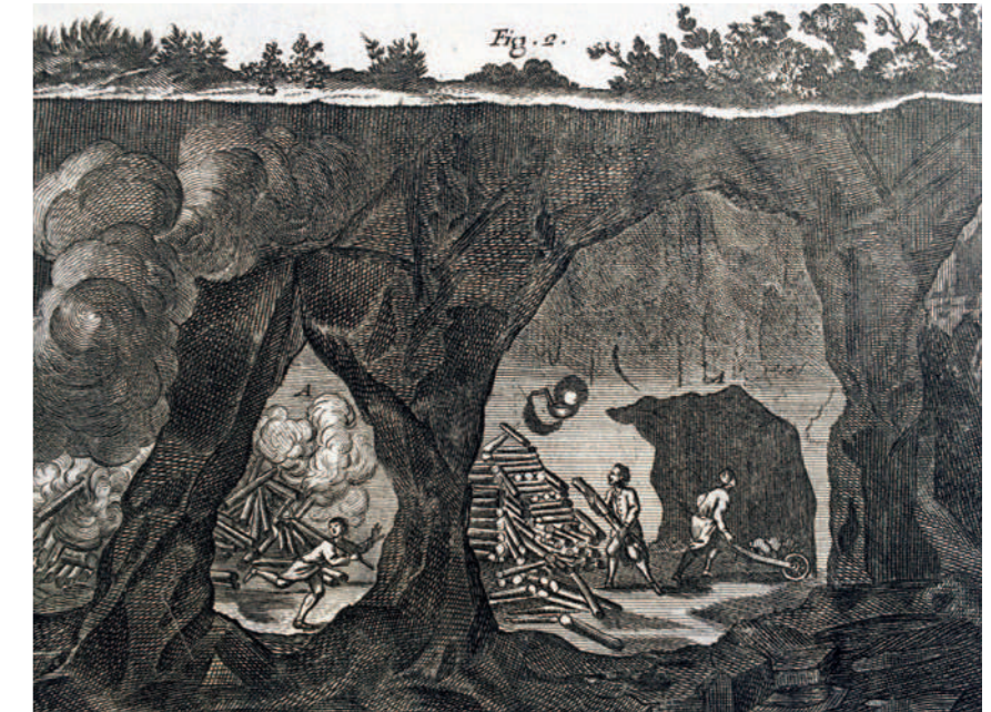
Creusement au feu (Encyclopédie de Diderot et d'Alembert, coll. J. Féraud).
